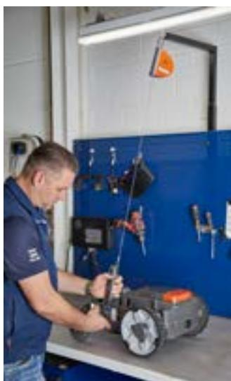
Das Gestell (4-Kant-Rohr) wird mit dem Montagesatz an der Lochtafel befestigt. (s. Bild)
