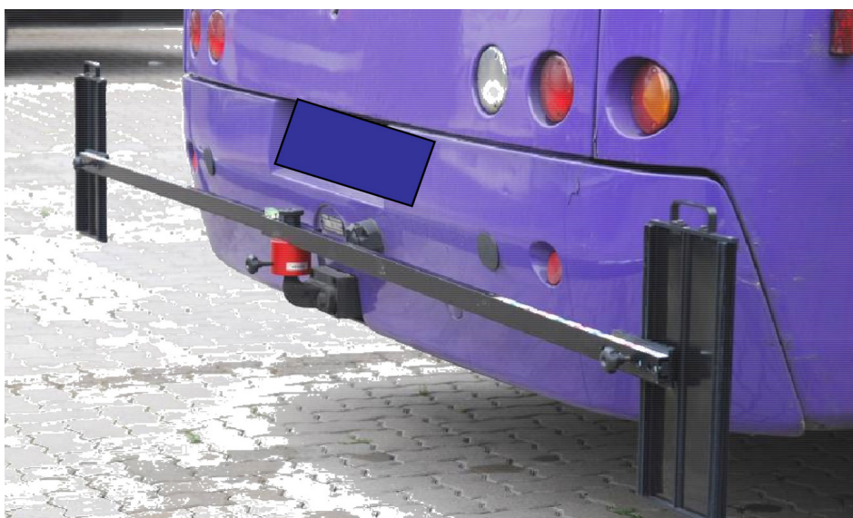
Nutzung der am Bus vorhandenen Anhängerkupplung mit AM1245 (truckaligner)
