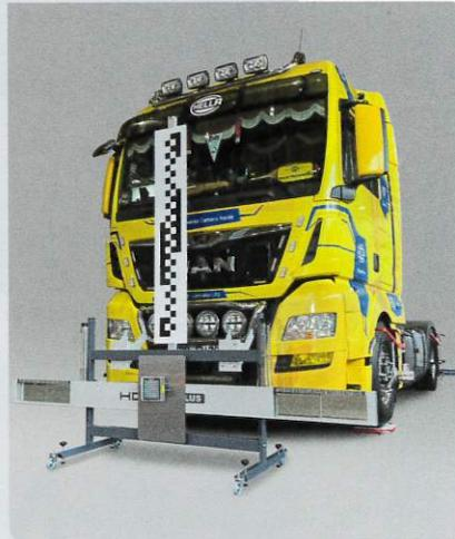
Mit Hilfe des Aufrüstsatzes ‚HD-30 Plus‘ lassen sich bestehende ‚HD-30 Easy Touch‘- und ‚HD-40 Easy Touch‘-Achsmessgeräte zur Justage von kamera- und radarbasierten Fahrerassistenzsystemen aufrüsten. Herzstück des Upgrades ist die Spiegel-Messtraverse mit feinjustierten Laserspiegeleinheiten und Zentrierskalen. Bild: Koch
