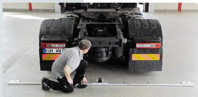
Einige Nutzfahrzeughersteller verlangen zum exakten Re-Kalibrieren der Kameras des digitalen Spiegelersatzsystems spezielle Markierungen am Werkstattboden. Eine professionelle Einstellhilfe hilft, die Rüstzeiten kurz zu halten. Bild: Wabcowürth
