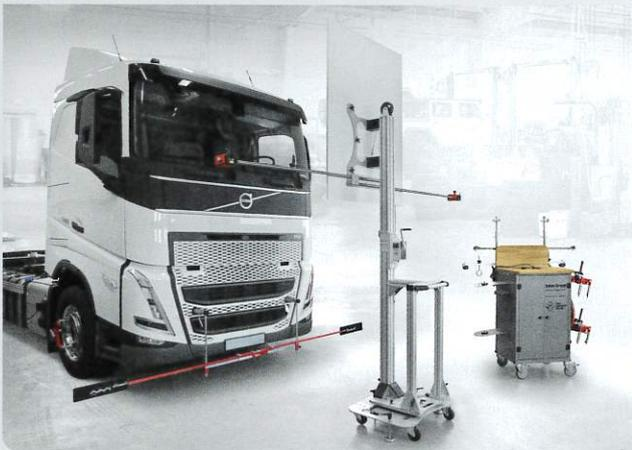
Mit entsprechendem Zubehör lassen sich Achsmesssysteme von Josam zum Kalibrierstand aufrüsten. Das gilt sowohl für die mechanisch-optischen ‚Laser-AM‘-Versionen als auch für die elektronischen, kamerabasierten ‚Cam-Aligner‘-Varianten. Bild: Josam
