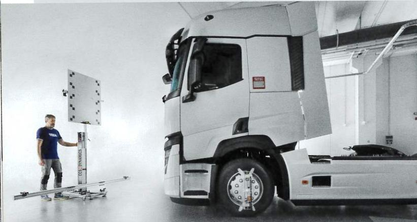
Nutzfahrzeug-Profis bekommen es zunehmend mit dem Kalibrieren und Justieren von kamera- und radarbasierten Fahrerassistenzsystemen zu tun. Bild: TEXA
