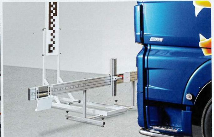
Zum fachgerechten Kalibrieren von Frontkameras muss das Target in eine vordere und eine hintere Position gebracht werden. Die Toolhersteller realisieren dies auf unterschiedliche Art und Weise. Bild: Haweka
