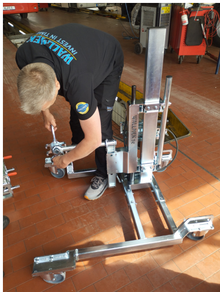
Gerald Riesland von Wallmek baut die Hydraulische Hebeeinheit im Autohaus Senden auf.
