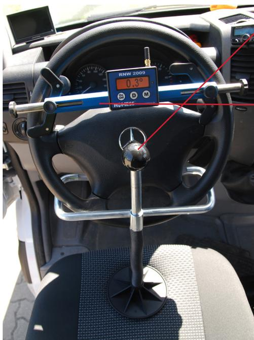
**Lenkrad - Einstellwaage - digital**
