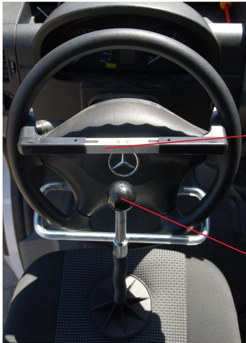
**Lenkrad - Einstellwaage
