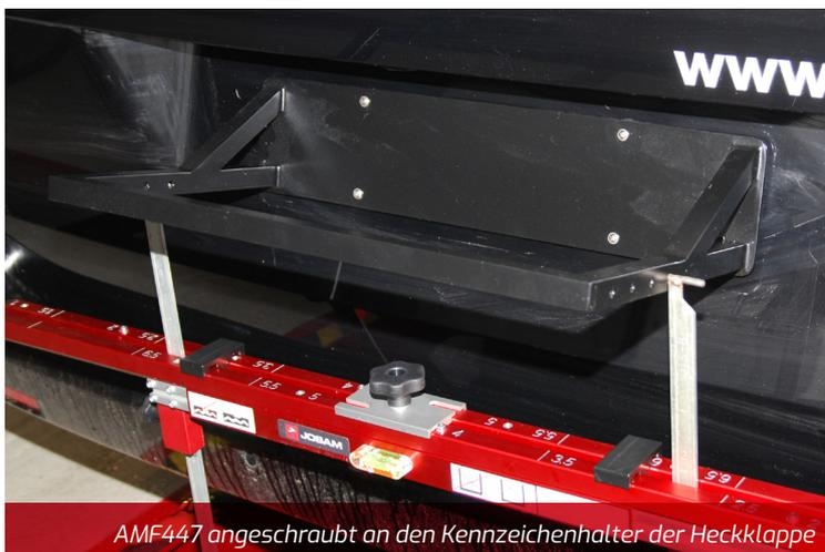
AMF447 angeschraubt an den Kennzeichenhalter der Heckklappe
