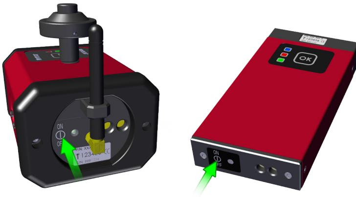
1. Drücken Sie die **EIN/AUS**-Taste auf den Kameras und der/den Neigungsmesseinheit(en). Sobald das Gerät ausgeschaltet ist, erlischt das grüne Licht.
