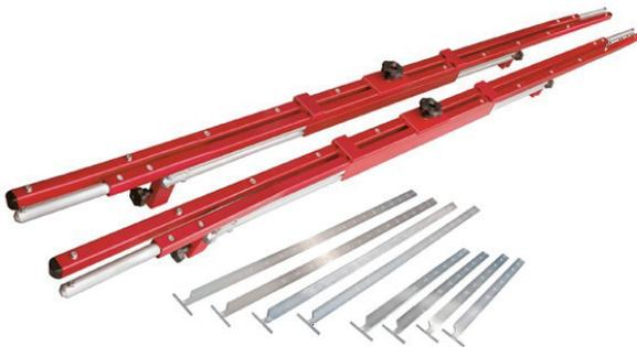
Die Messrahmen funktionieren entsprechend einem Selbstzentrierungsprinzip. Wird er an einem Fahrzeug montiert, bestimmt er die Fahrgestell-Mittellinie, die die Standard-Referenz für das Cam-aligner darstellt. Die reflektierenden Zielpunkte werden am Ende jedes Messrahmens angeordnet.
