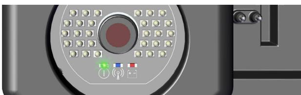
5. Nachdem die Aufladephase beendet wurde, wird die Batteriekapazität aktualisiert. Die rote LED vor dem Kamerasensor erlischt und die grüne LED leuchtet auf.
