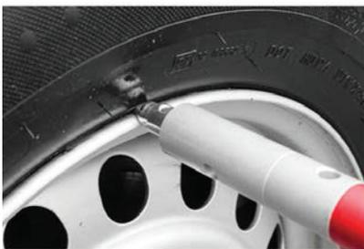
Für leichte Nutzfahrzeuge, zum Beispiel Vans, Transporter usw., verwenden Sie das kleinere Bein mit dem Van-Haken für den Radhalter und platzieren Sie es zwischen Felge und Reifen.
