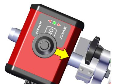
Nehmen Sie die andere Kamera und stellen Sie diese auf der anderen Seite des Fahrzeugs mit dem Pfeil nach innen auf die hinterste Achse.
