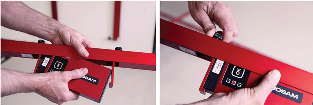
Entfernen Sie den Neigungsmesser aus der TC-395 Ladestation. Montieren Sie das Neigungsmessgerät CA1007 auf der Neigungsmessleiste CA1065, indem Sie das Gerät in den Schlitz der Schiene einlegen und dann die Schrauben anziehen, um das Gerät an der Leiste zu fixieren.
