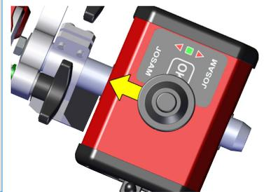
Nehmen Sie die Kamera von der Hinterachse und stellen Sie sie mit dem Pfeil nach innen auf die Vorderachse. Richten Sie die Kamera einigermaßen horizontal auf den am weitesten entfernten Marker und drücken Sie die Taste **OK** an der Kamera.
