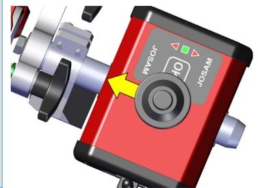
Nehmen Sie die Kamera von der hintersten Achse und stellen Sie sie mit dem Pfeil nach innen auf die vorderste Achse. Richten Sie die Kamera einigermaßen horizontal auf den am weitesten entfernten Marker und drücken Sie die Taste **OK** an der Kamera.
