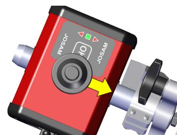
Nehmen Sie die Kamera von der Hinterachse und stellen Sie sie mit dem Pfeil nach innen auf die Vorderachse. Richten Sie die Kamera einigermaßen horizontal auf den am weitesten entfernten Marker und drücken Sie die Taste **OK** an der Kamera.
