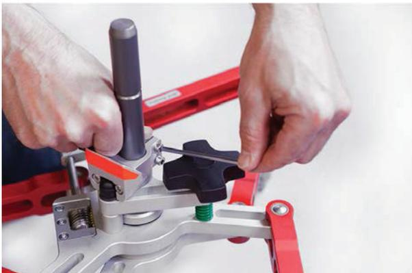
Legen Sie den Referenzblock so weit wie möglich auf der Radhalterachse nach innen. Stellen Sie sicher, dass der Referenzblock über die Radhaltermutter (wie abgebildet) passt.
