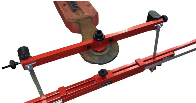
Montieren Sie den Anhängerkupplungsadapter des Sturz- und Anhänger-Adapter-Kit TC-410 an der Abschleppöse.
