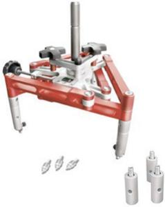
Der Radadapter wird verwendet, um die Kameras an den Rädern des Fahrzeugs zu befestigen. Der Radadapter wurde entsprechend einem Stativ-Prinzip konzipiert, um die höchstmögliche Genauigkeit bei der Messung zu ermöglichen und kann bei Aluminium- sowie Stahl-Felgen in den Größen 12" – 22,5" verwendet werden.
