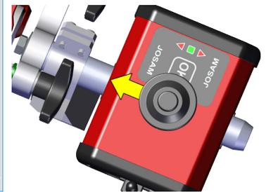
Setzen Sie die Kamera auf die hinterste Achse mit dem Pfeil nach innen zeigend.
