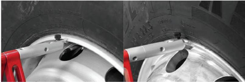
Sie werden durch Anpassen der Haken am Ende der Radhalterbeine, entweder auf der Innenseite der Felge oder zwischen Felge und Reifen, je nach Felge, angebracht. Durch Drehen des Knopfes auf der Seite des Adapters wird dieser befestigt.
