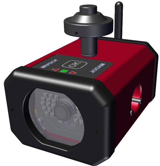
Das Bild wird mittels eines Mikroprozessors innerhalb des Kamerasensors analysiert und die Informationen werden mithilfe der drahtlosen Kommunikation an den Computer gesendet. Der Computer beendet die Berechnungen und zeigt die drei Winkel  $\alpha$  (alfa),  $\beta$  (beta) und Sturz sowie die Entfernung zum Ziel an. Diese Parameter werden dann von der Computer-Software verwendet, um die Radwinkel zu berechnen.
