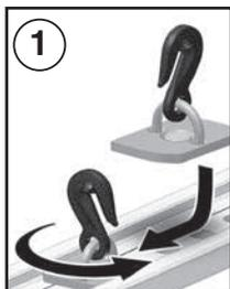
1. Den Verankerungshaken JO30000410 in die Schiene einsetzen. Gegen den Uhrzeigersinn drehen, um den Haken zu sichern.
